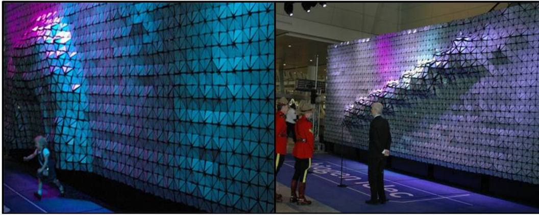
(شكل 3) يوضح مجموعة من الشاشات التفاعلية التي تعيد تشكيل نفسها بناء على الحركة أو الصوت
